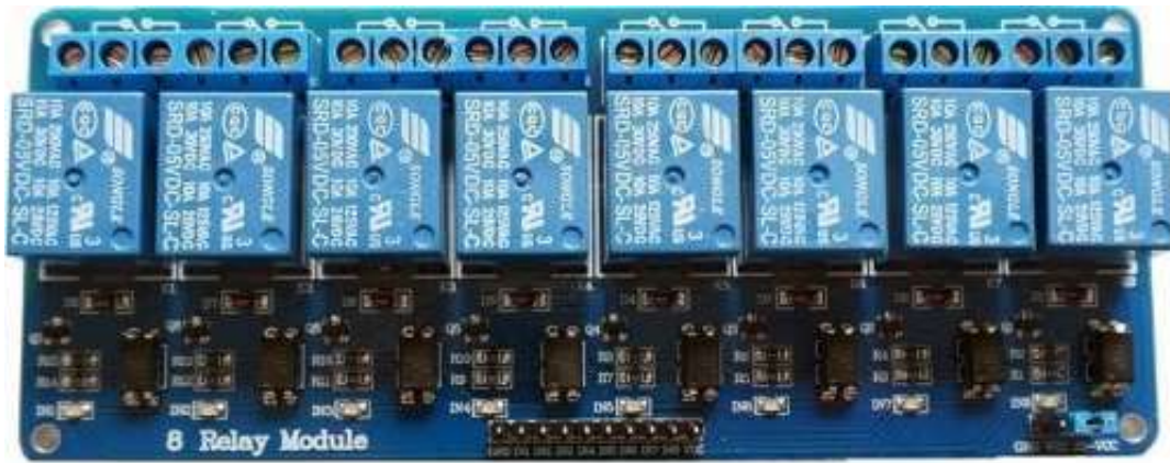
Figura 14. Módulo de relés de 8 canales. Por Galindo, A. (2018)
