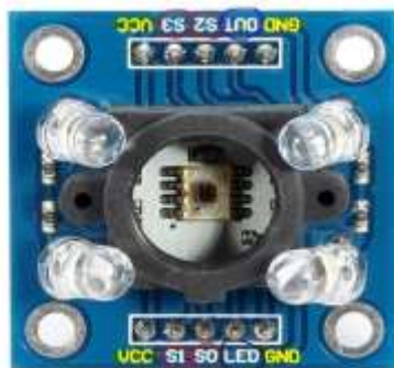
Figura 6. Sensor GY-31 RGB. Por Caldas, M. (2017)
