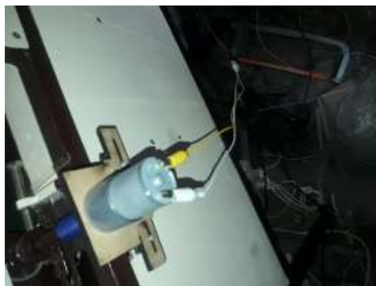
Figura 43. Motor DC conectado a la banda
