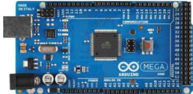
Figura 5. Tarjeta Arduino Mega. Por Hernández, L. (2018),
