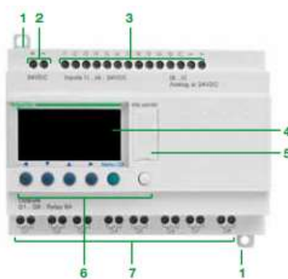
Figura 4. Partes de Zelio PLC. Por ZELIO (2007)
