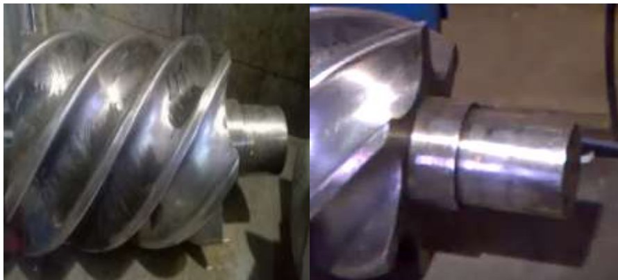
Figura 43: Rellenado y maquinado del eje del perfil cóncavo. Elaboración: Fuente propia (2018)
