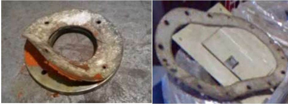
Figura 23: Brida y sello de la tapa del motor. Elaboración: Fuente propia (2018)
