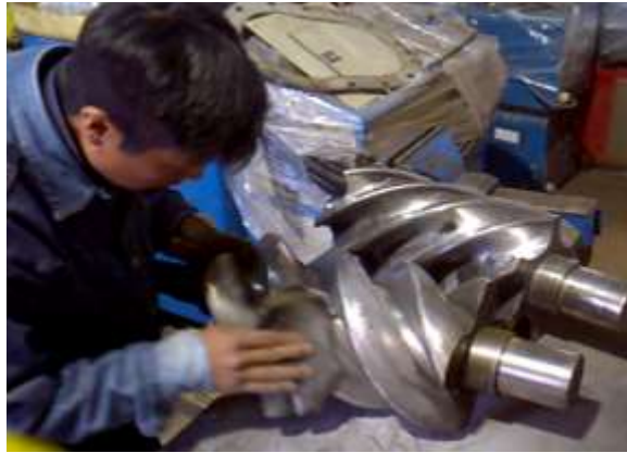
Figura 41: Corrección de perfiles convexos y cóncavos. Elaboración: Fuente propia (2018)
