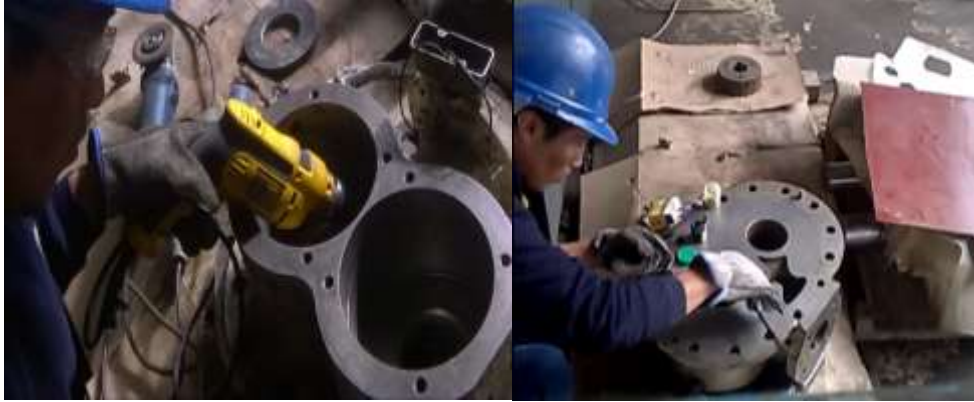
Figura 39: Rectificado de tapas laterales y Alojamiento del rodamiento. Elaboración: Fuente propia (2018)
