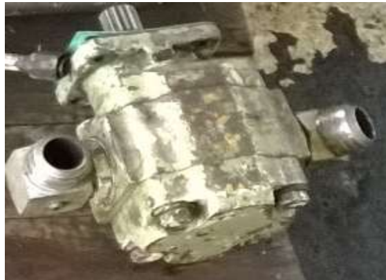
Figura 22: Bomba de piñones. Elaboración: Fuente propia (2018)
