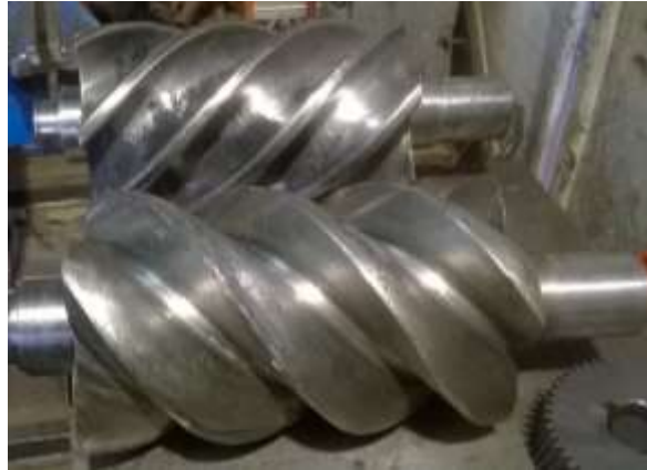
Figura 19: Rotores helicoidales. Elaboración: Fuente propia. (2018)
