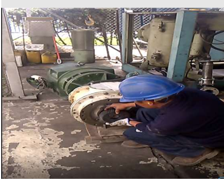
Figural 4: Sistema de transmisión (Piñones) Fuente: Elaboración propia (2018)
