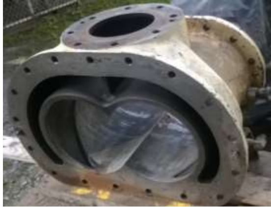
Figura 44: Corrección de desgastes en cilindros. Elaboración: Fuente propia (2018)
