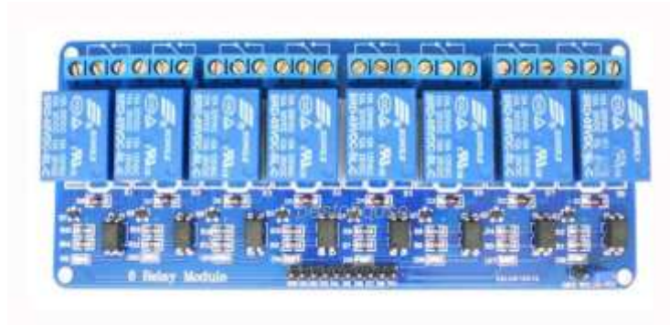
FIGURA 4. Módulo Shield de relés de 8 canales
