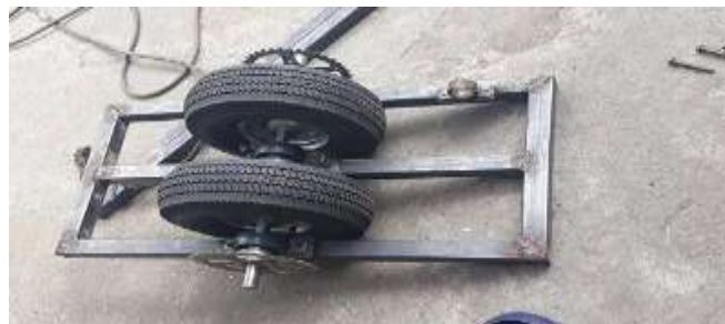
Figura 35. Fijación de los ejes en chavetero
