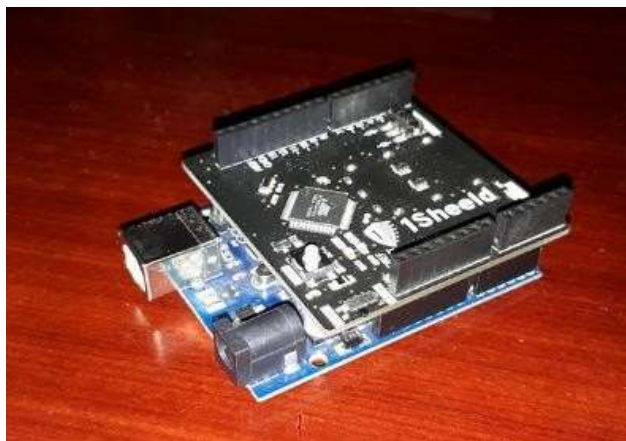
Figura 9. Unión de 1Sheeld y Arduino UNO
