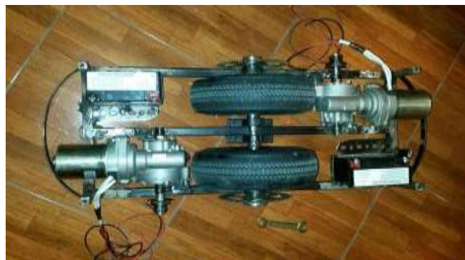
Figura 15. Motores reductores y baterías.
