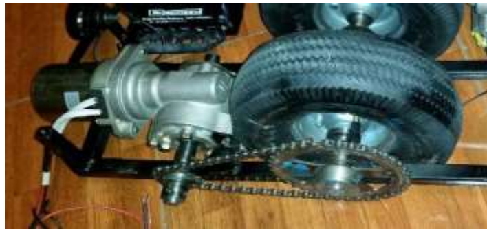
Figura 30 .Piñón en el eje del motor
