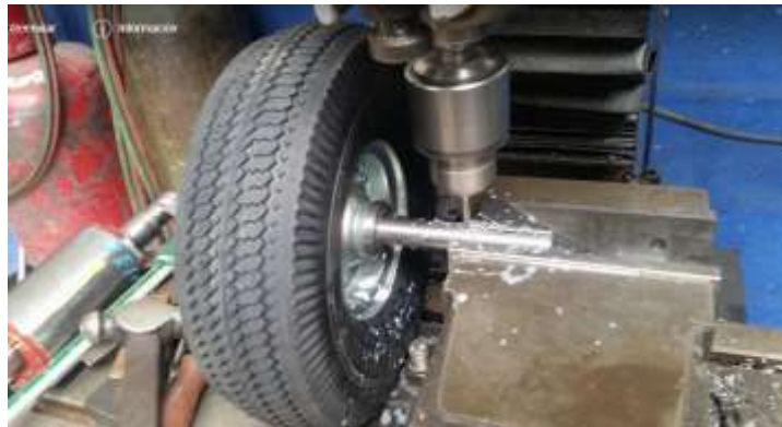
Figura 29. Construcción de chavetero en eje
