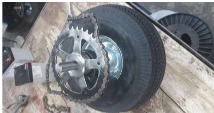
Figura 31. Acople del piñón en el eje
