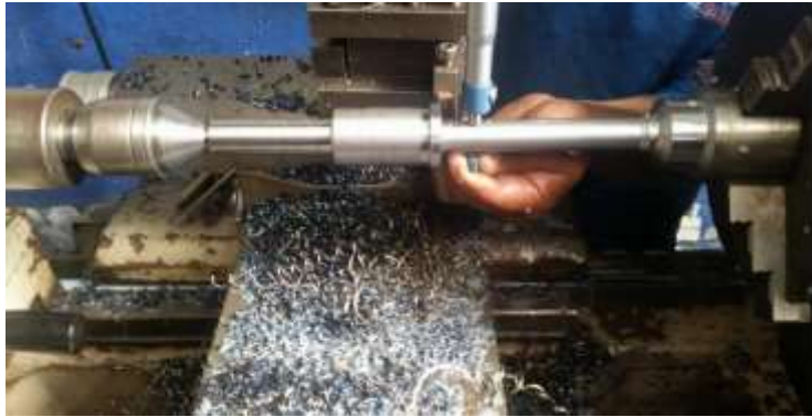
Figura 28. Construcción del eje para la llanta
