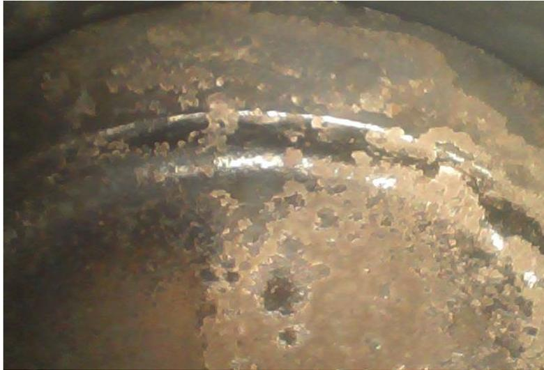
*Nota.* En esta figura se puede observar la cabeza del pistón del cilindro 1 sin la instalación del sistema generador de hidrógeno.
