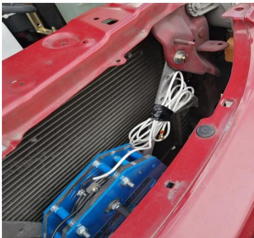
*Nota.* En esta figura se muestra la parte delantera del radiador del vehículo en donde se realiza la conexión del reactor de hidrógeno.
