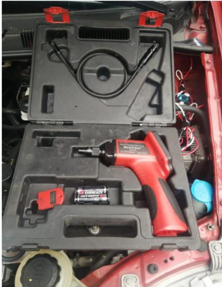
*Nota.* En esta figura se muestra la herramienta boroscopio utilizada en el proceso de instalación del sistema generador de hidrógeno.
