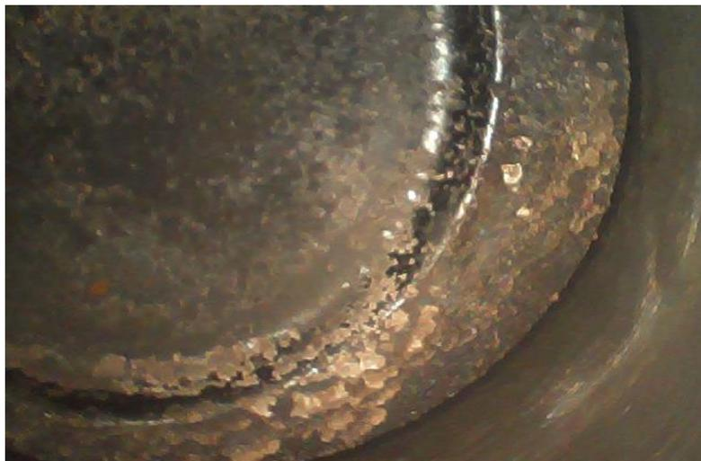
*Nota.* En esta figura se puede observar la cabeza del pistón del cilindro 1 con la instalación del sistema generador de hidrógeno.
