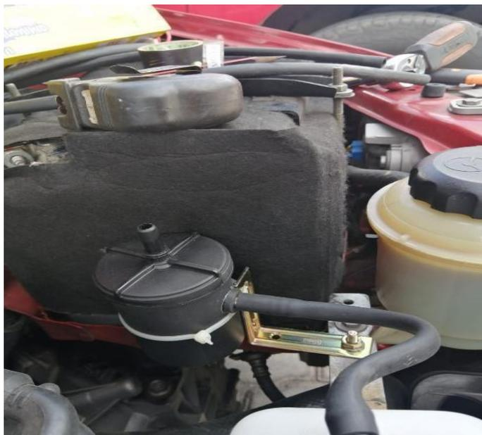
*Nota.* En esta figura se observa el filtro instalado al lado izquierdo de la batería del vehículo.
