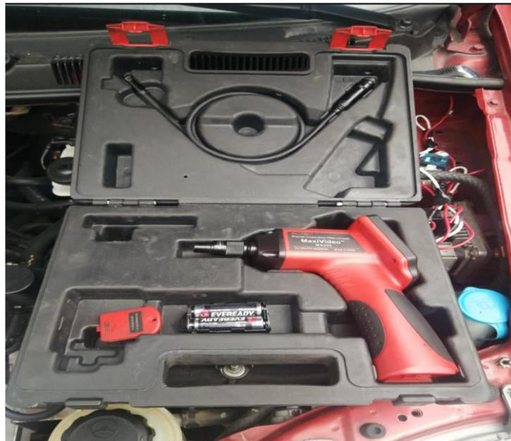
*Nota.* En esta figura se observa la herramienta boroscopio y sus piezas a utilizar para obtener las imágenes de los cilindros.
