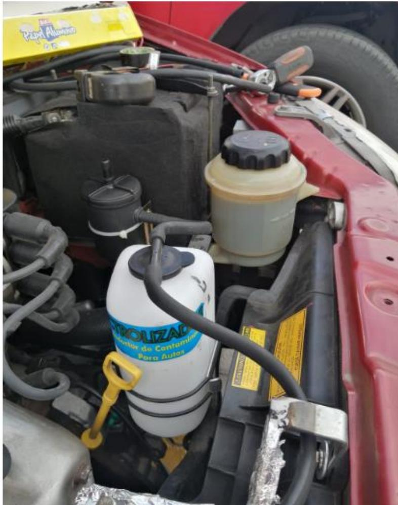
*Nota.* En esta figura se muestra la instalación de los componentes del sistema generador de hidrógeno.
