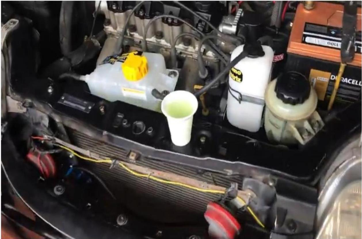
*Nota.* En esta figura se aprecia el sistema generador de hidrógeno instalado en el auto aveo family.
