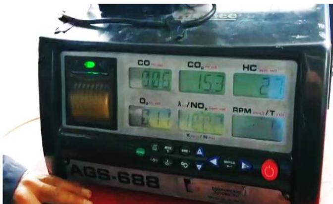
*Nota.* En esta figura se aprecia la máquina analizadora de gases con la que se tomó las pruebas de gases y sus primeros valores.
