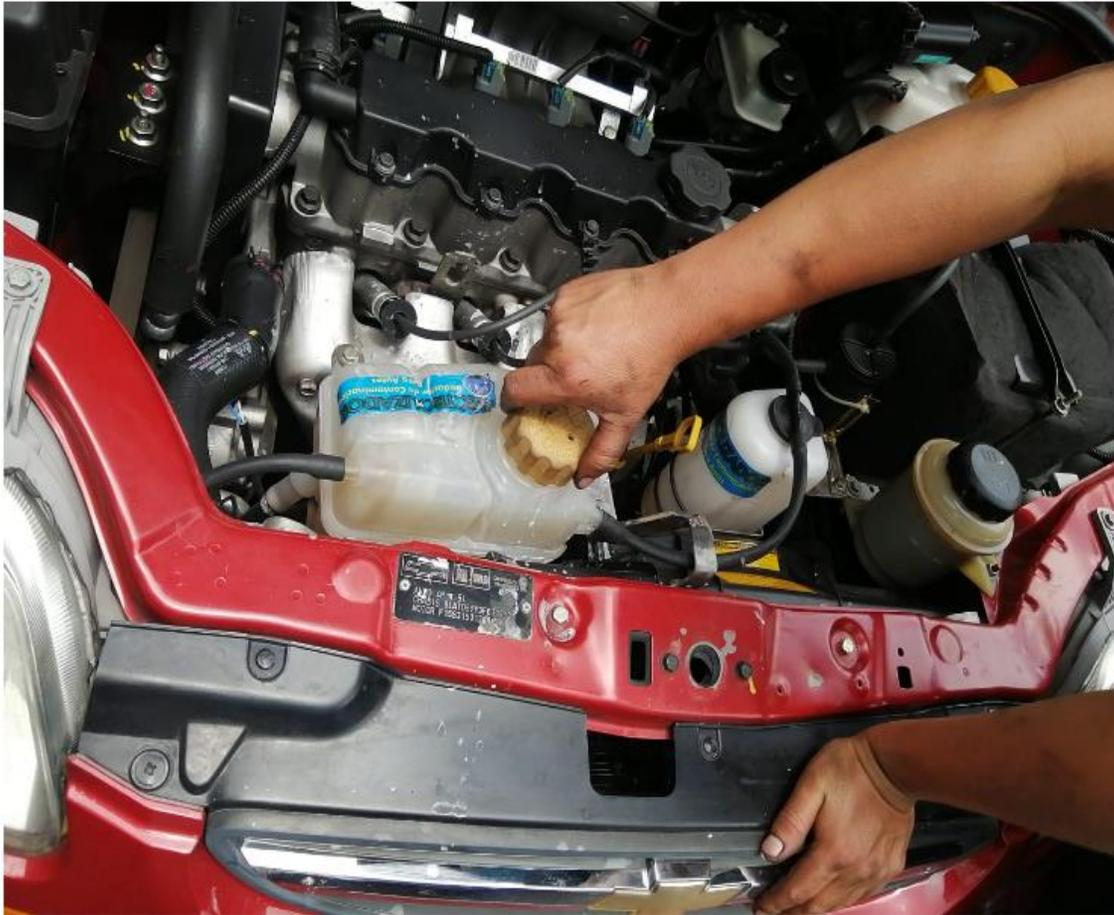
*Nota.* En esta figura se observa el sistema generador de hidrógeno en funcionamiento en el auto aveo family.
