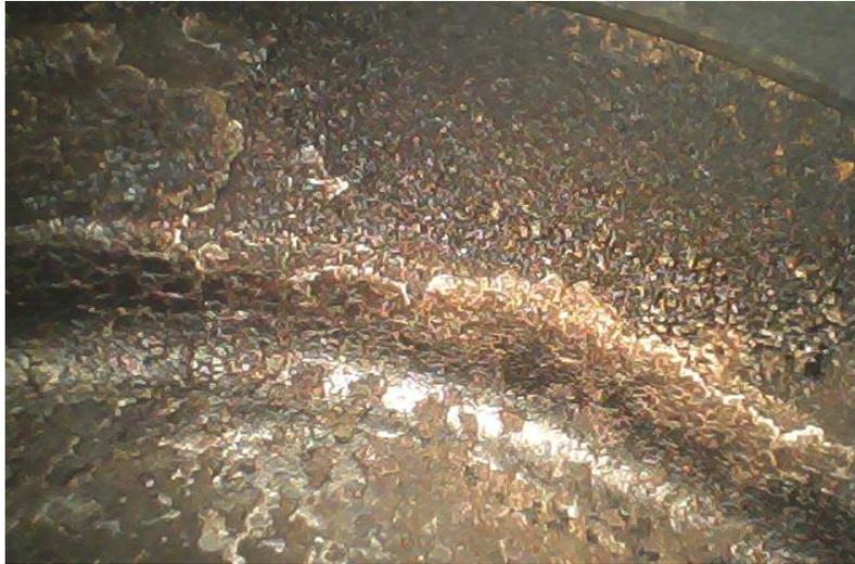
*Nota.* En esta figura se puede observar la cabeza del pistón del cilindro 2 sin la instalación del sistema generador de hidrógeno.
