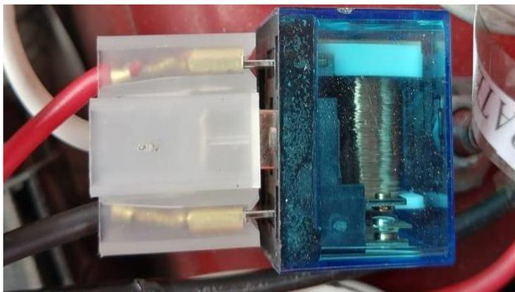
*Nota.* En esta figura se aprecia el relé el cual es utilizado en el circuito eléctrico.
