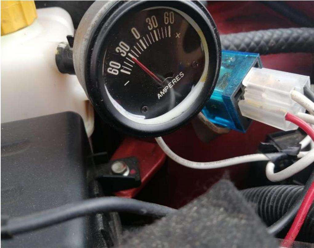
*Nota.* En esta figura se observa el reloj amperímetro que mide en que amperaje está trabajando el sistema generador de hidrógeno.
