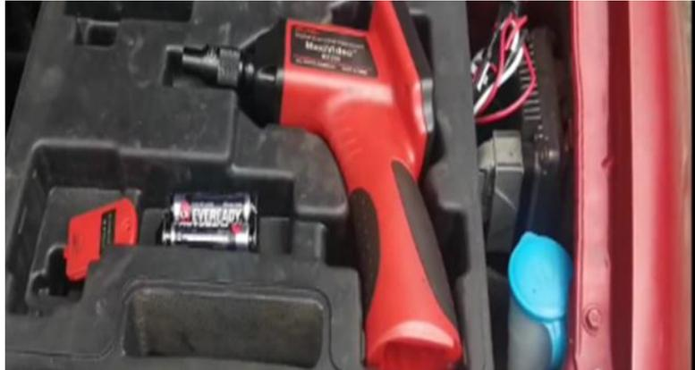
*Nota.* En esta figura se observa la herramienta boroscopio y sus piezas a utilizar para obtener las imágenes de los cilindros.
