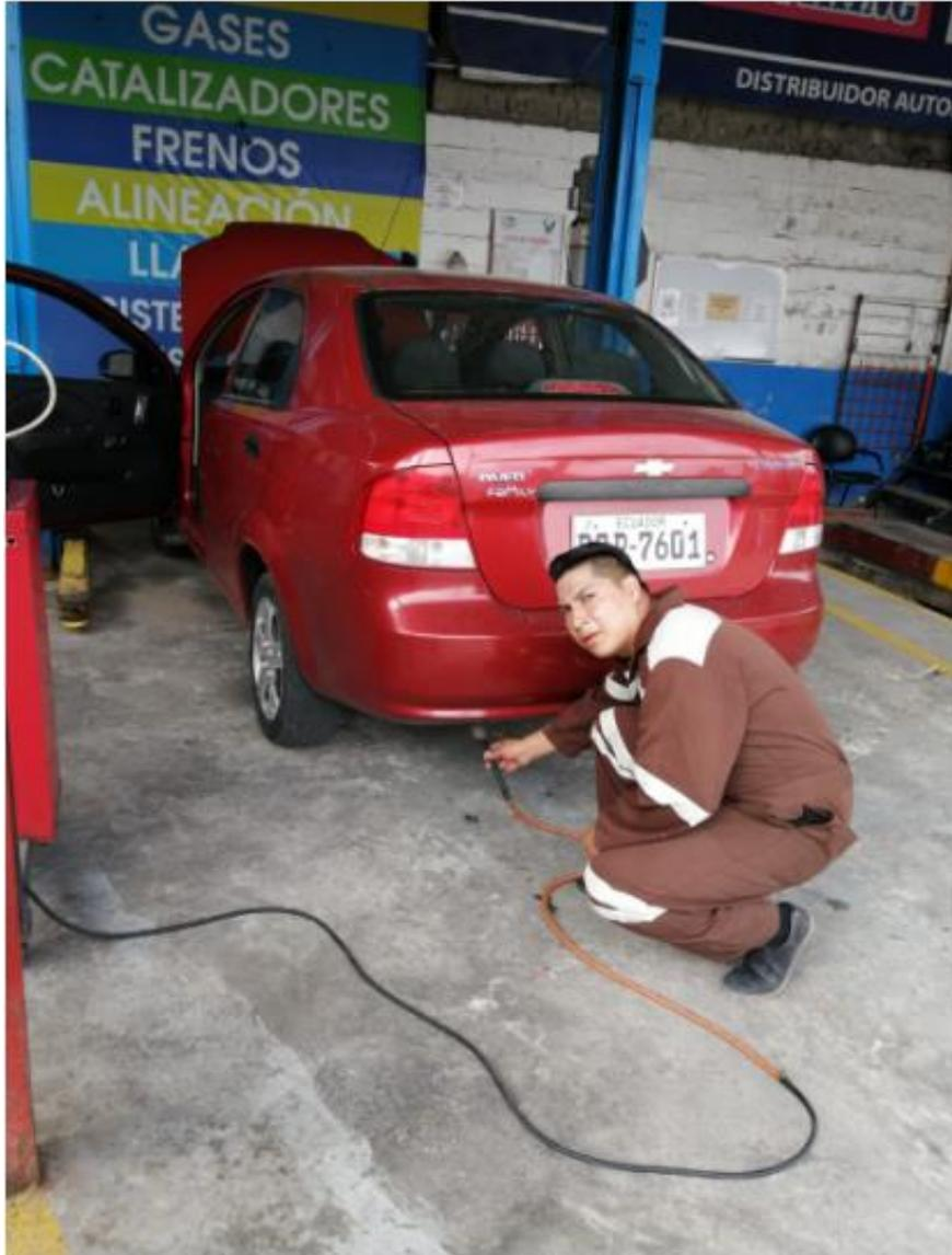
*Nota.* En esta figura se muestra que se está realizando la prueba de gases en el auto aveo family.
