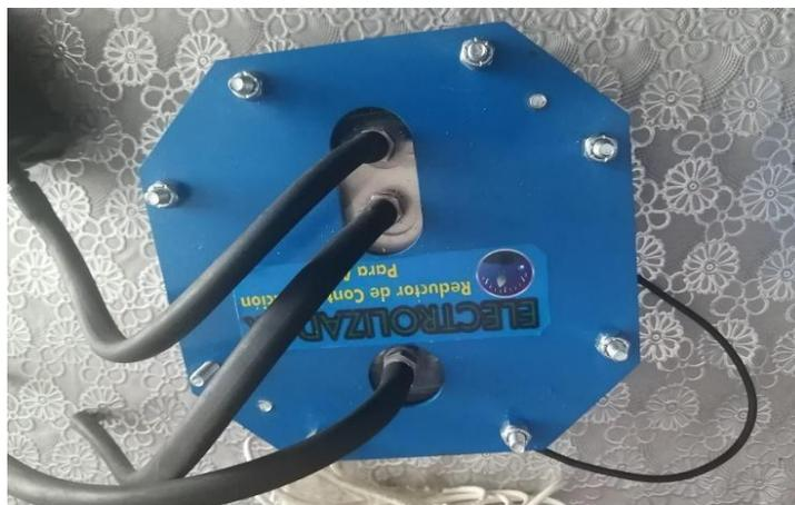
*Nota.* En esta figura se puede observar el reactor donde se genera el hidrógeno.
