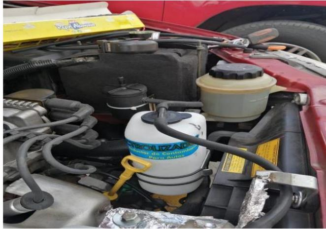
*Nota.* En esta figura se muestra la trampa de agua instalada en el vehículo detrás del electroventilador.
