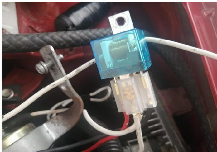
*Nota.* En esta figura se observa el relé instalado al lado derecho de la caja de fusibles.
