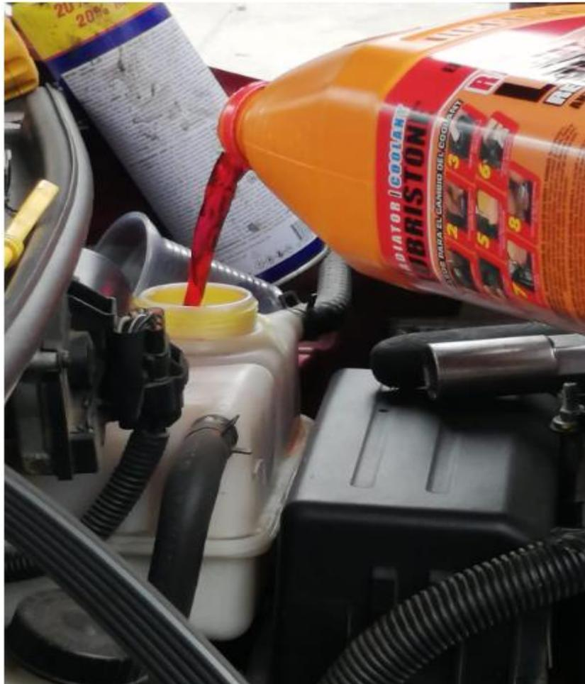
*Nota.* En esta figura se observa el cambio de líquidos en el auto antes de la instalación del generador de hidrógeno.
