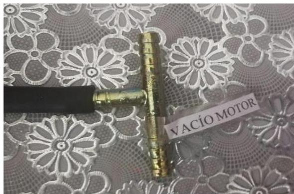
*Nota.* La figura muestra un acople en forma de “t”, que se conecta hacia el vacío del motor.
