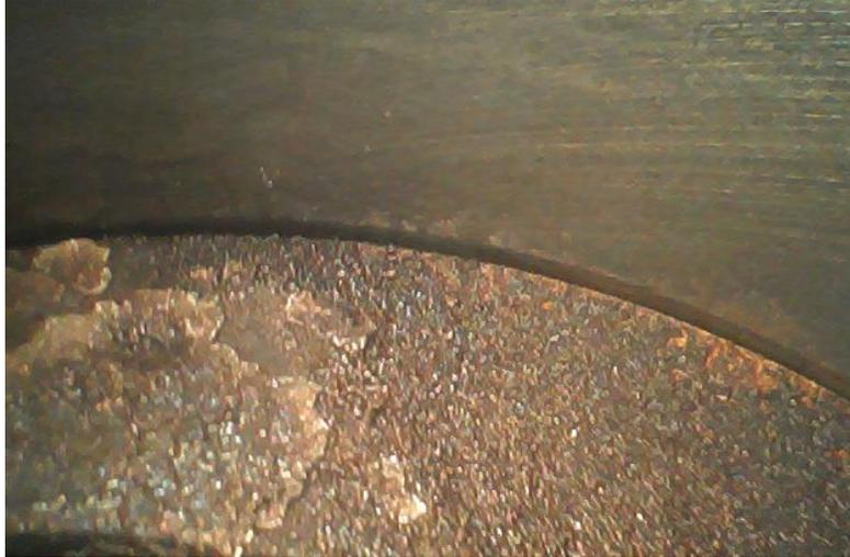
*Nota.* En esta figura se puede observar la cabeza del pistón del cilindro 3 sin la instalación del sistema generador de hidrógeno.
