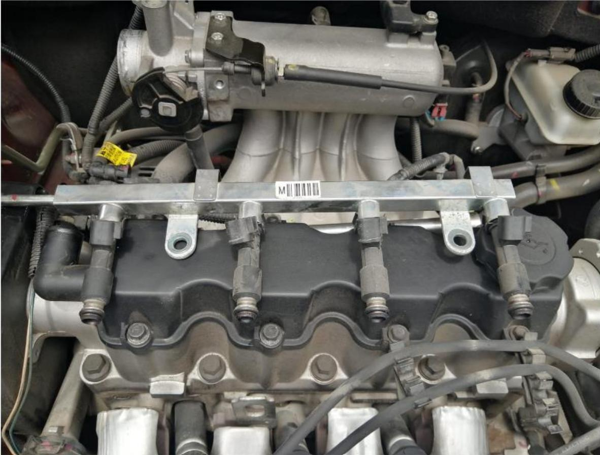
*Nota.* En esta figura se observan los inyectores limpios antes de la instalación del generador de hidrógeno.
