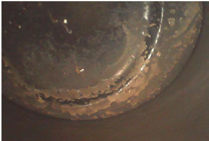
*Nota.* En esta figura se puede observar la cabeza del pistón del cilindro 2 con la instalación del sistema generador de hidrógeno.
