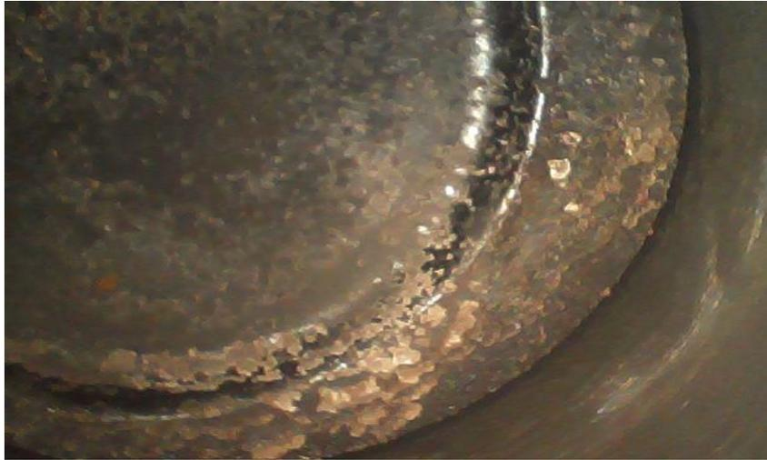
*Nota.* En esta figura se puede observar la cabeza del pistón del cilindro 4 sin la instalación del sistema generador de hidrógeno.
