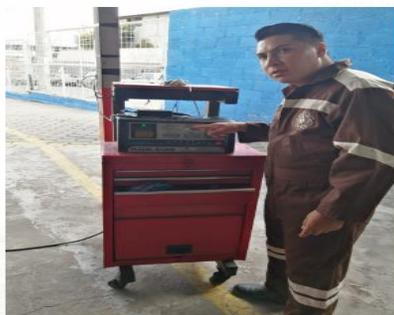
*Nota.* En esta figura se muestra la máquina encendida y calibrada para la impresión de las mediciones de los gases contaminantes.
