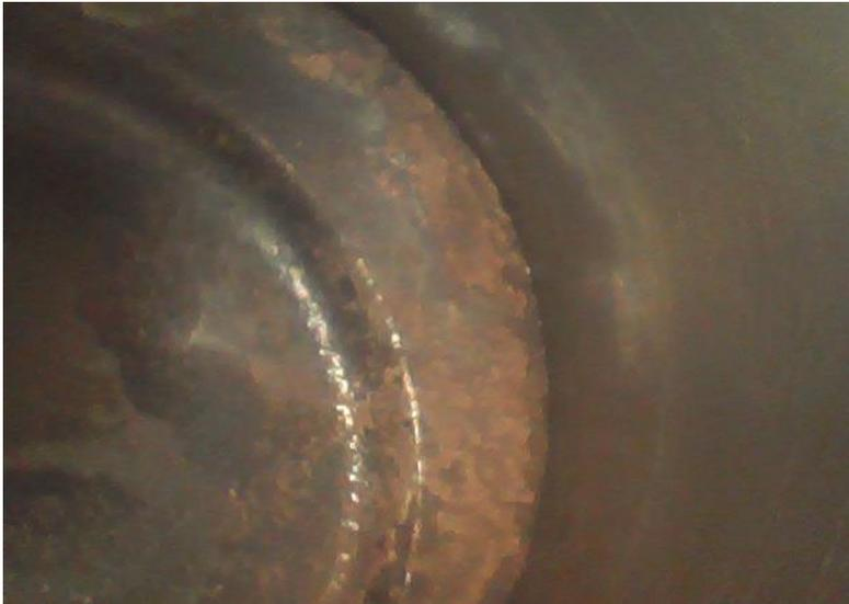
*Nota.* En esta figura se puede observar la cabeza del pistón del cilindro 3 con la instalación del sistema generador de hidrógeno.
