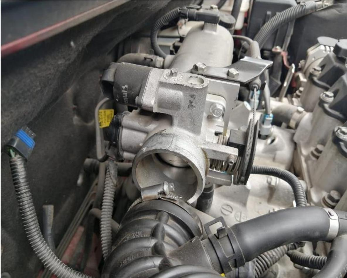
*Nota.* En esta figura se observa el cuerpo de aceleración antes de la instalación del sistema de hidrógeno.
