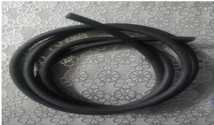
*Nota.* En esta figura se muestran las mangueras que son utilizadas para el recorrido del hidrógeno.
