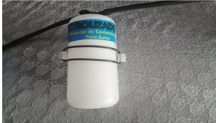
*Nota.* En esta figura se muestra la trampa de agua la cual es utilizada para retener los vapores de agua
