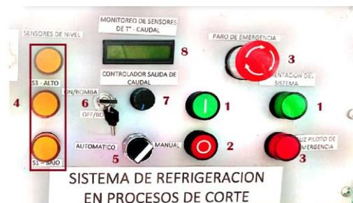
*Nota.* En la figura se muestra el tablero de control con cada uno de los componentes del Sistema de refrigeración.
