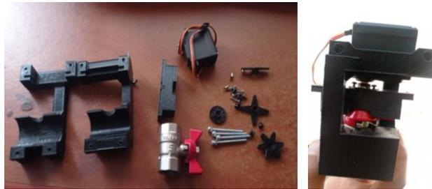
*Nota.* En la figura se puede las piezas a ser armadas y posteriormente el armado de la válvula proporcional de paso automática.
