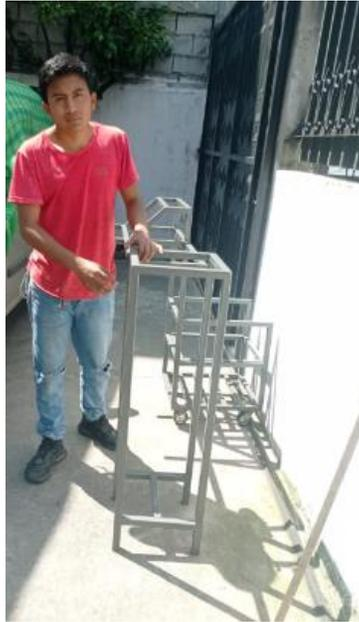
*Nota.* En la figura se muestra la construcción de la estructura en donde va a ir el tanque con el líquido refrigerante y asimismo la estructura del tamizador.
