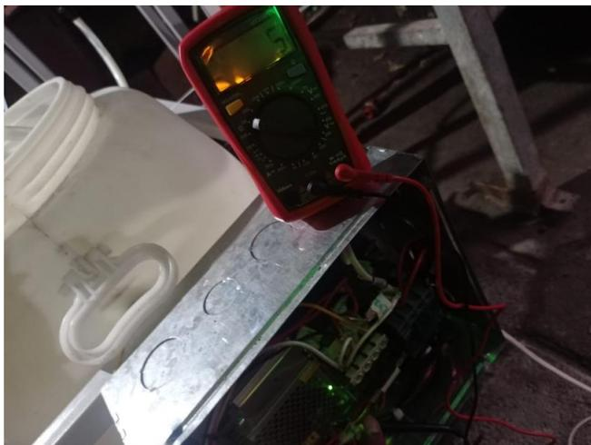
*Nota.* En la figura muestra la medición de voltaje de la fuente que alimenta el bloque de relés y demás componentes que necesitan de 5v para su funcionamiento.
