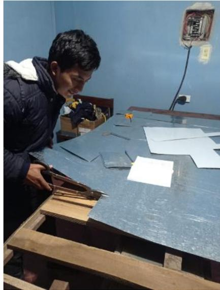
*Nota.* En la figura se puede visualizar la plancha de tol de 0,5mm que se utilizó para realizar la parte del tablero de control y el tamizador que se necesita para el proyecto.
