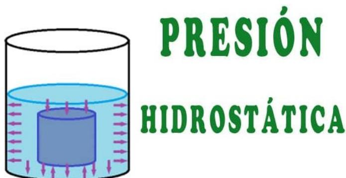
*Nota.* En la figura se muestra la relación entre la altura de la columna y la presión del fluido que es constante. Tomado de Wordpress, por D. Cervantino, 2015 (<https://es.files.wordpress.com/2015/02.png>).
