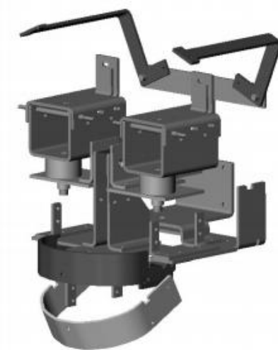
Figura 4. Diseño de estructura metálica de una cabeza robótica
