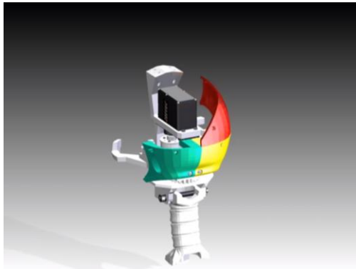
Anexo 9. Armado de la parte baja, trasera del cráneo.
