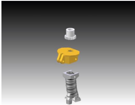
Anexo 20. Ensamblaje de engranaje principal y bisagra de cuello.
