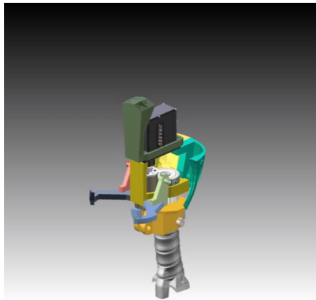
Anexo 27. Ensamblaje de soporte frontal.
